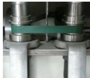
Comando a cintino ogni due fusi Two Spindle Tape Drive
